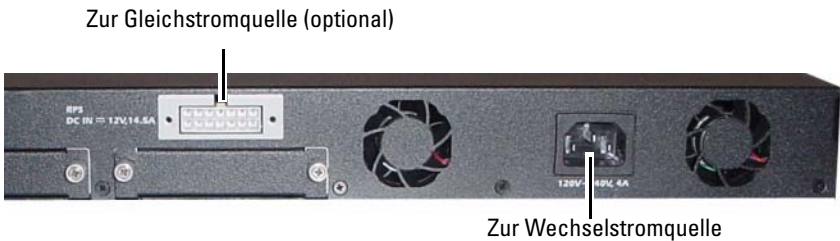
Abbildung 1-15. Wechselstrom- und Gleichstromversorgung zum Switch
